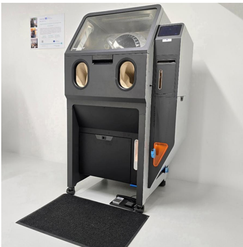
SLS Sift - Uređaj za čišćenje i reciklažu materijala
