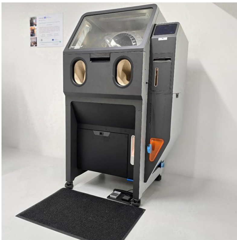
SLS Blast - Pjeskara za finu obradu izrađenih djelova
